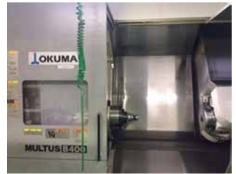
5軸旋盤複合加工機 MULTUS B400
