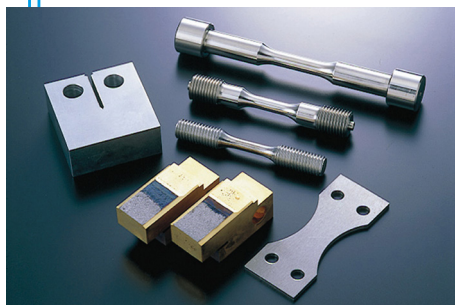
はんだコイルから採取した「微小引張試験片」 平行部直径0.5mm
