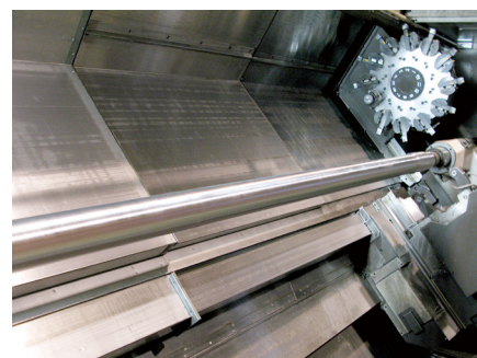
シャフトの切削加工(L/D=70以上)
